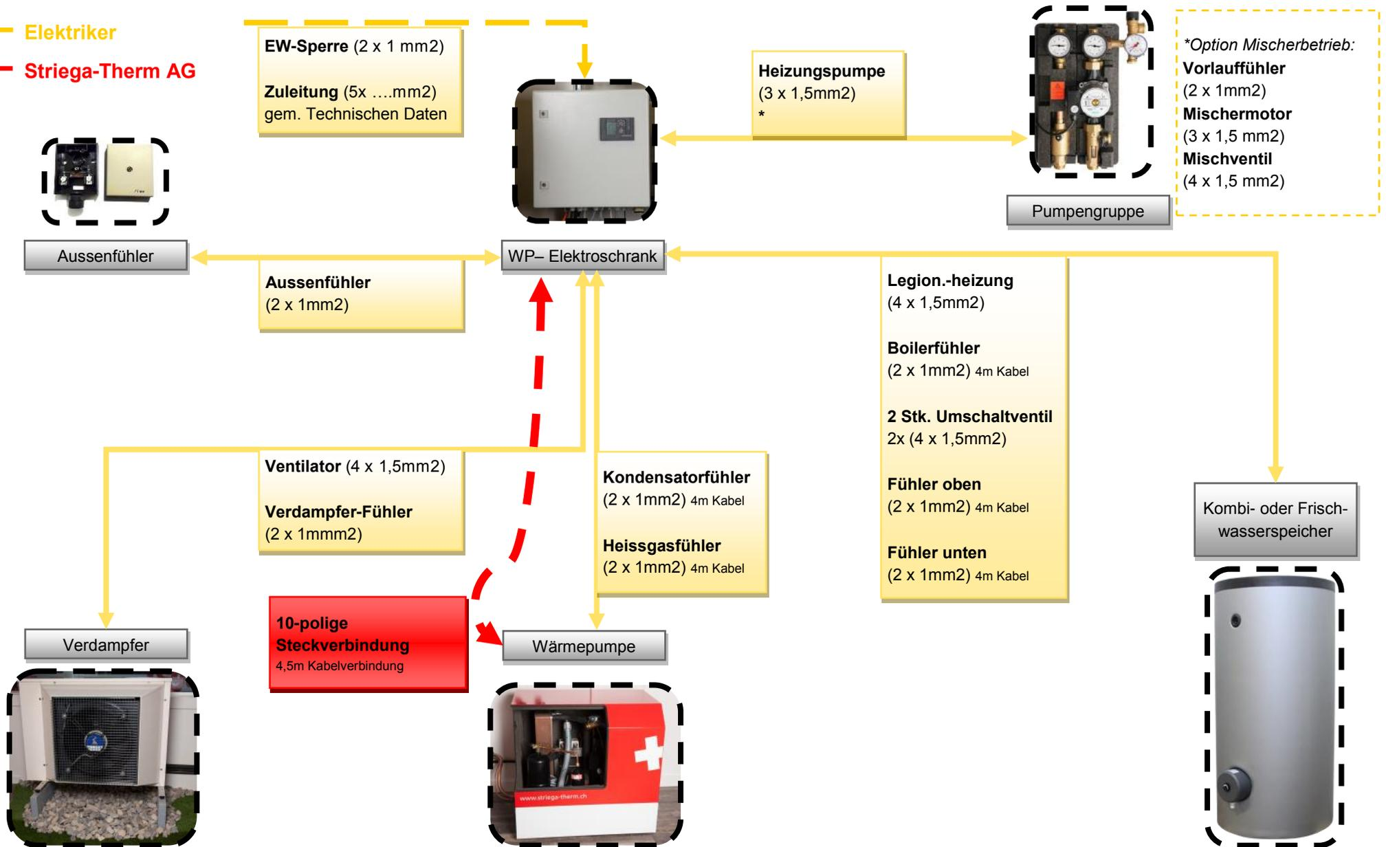
Sollten die bestehenden Kabellängen (Fühler) nicht ausreichen, nach Bedarf mit mind. 1mm<sup>2</sup> (Kabelquerschnitt) verlängern.
